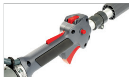
L'interrupteur on/off « AlwaysOn » retourne automatiquement sur la position de démarrage chaque fois que l'on arrête le moteur, ce qui évite de le noyer.
