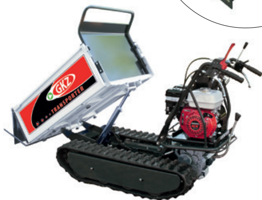
GK 500 HEi Exécution avec pont et parois latérales (vindage hydraulique)
