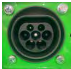
Standard: prise Type 2 sur la machine
