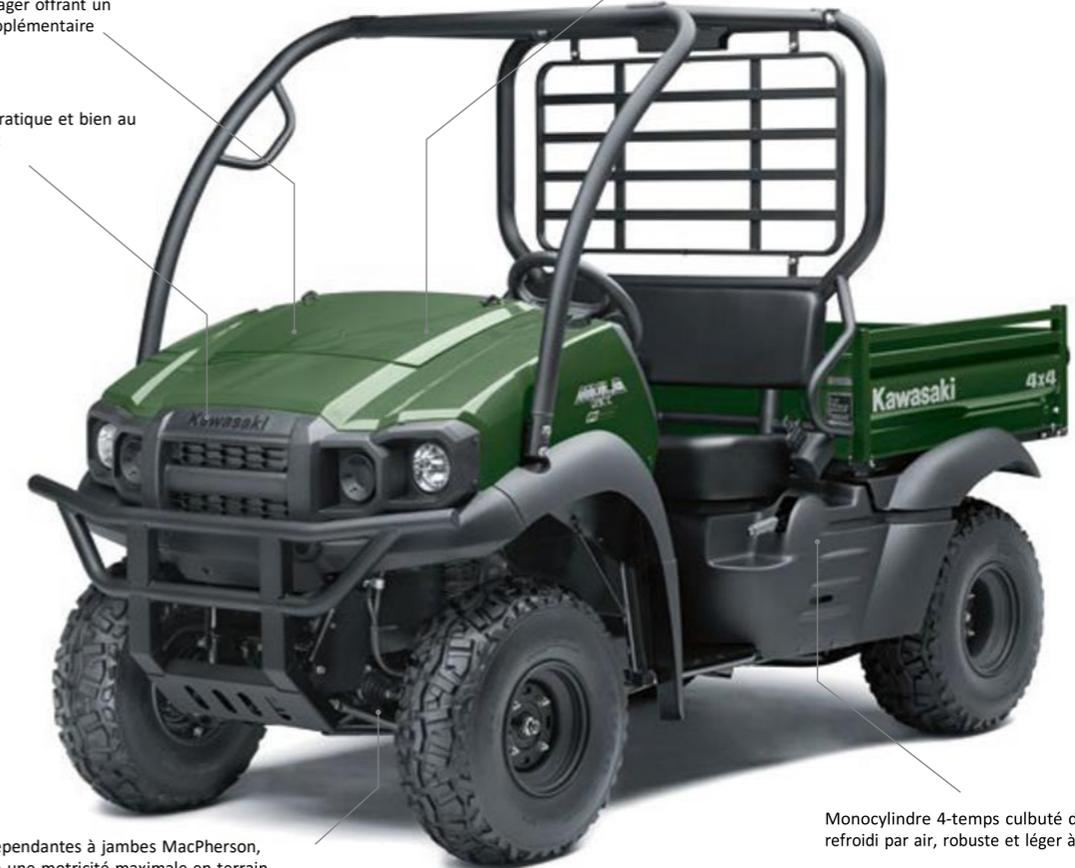
Suspensions avant indépendantes à jambes MacPherson, assurant à chaque roue une motricité maximale en terrain accidenté sans avoir à forcer sur la direction
